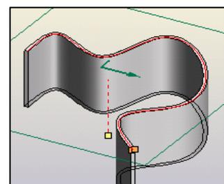
นอกจากนี้อาจสร้าง profiles ที่มีรูปแบบอิสระอื่น ๆ อีก โดยใช้คำสั่ง “Spline และ Thin” ดังภาพ
